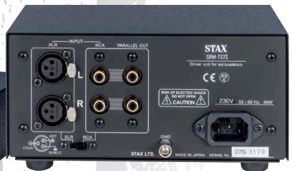
Je ein symmetrischer und unsymmetrischer Quelleneingang (wechelseitig schaltbar) und ein Ausgang
